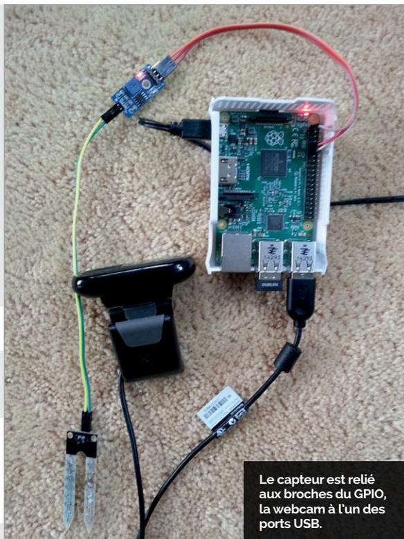
Le capteur est relié aux broches du GPIO, la webcam à l'un des ports USB.
