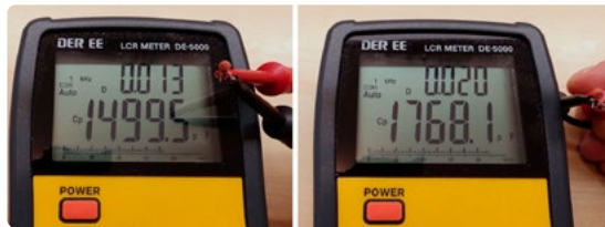
Figure 4. Ces condensateurs « de référence » de 1 nF chacun sont problématiques.
