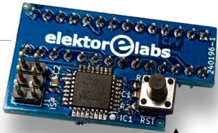
Figure 4. Carte d'adaptation de l'ATmega328PB-au-STC15W408AS, configurée pour le développement de logiciel.
