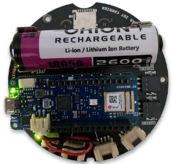
Figure 3 . Le support de batterie permet d'obtenir un kit Oplà IoT portable.
