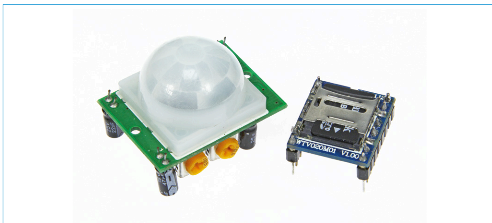
Figure 2. Le module son et le détecteur de mouvement PIR.
